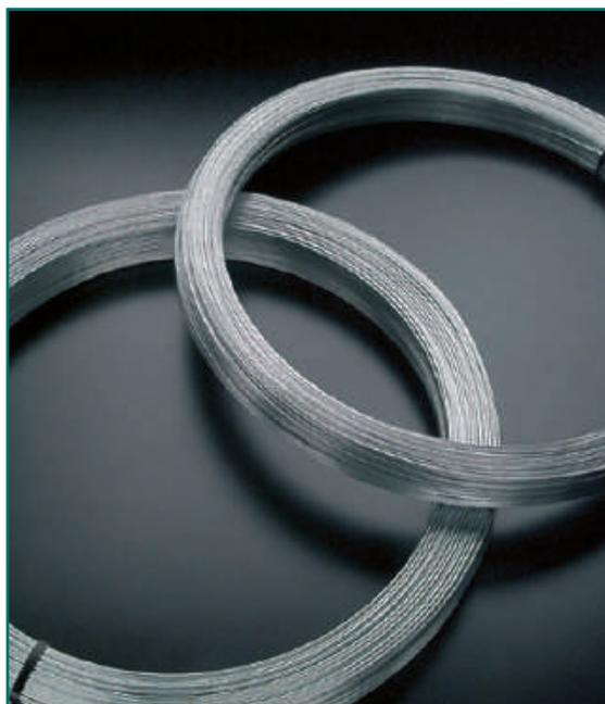
Filo d'acciaio ad elevato contenuto di carbonio, con rivestimento costituito da una lega di zinco (95%) ed alluminio (5%). Rispetto al Galvatec, Galvatec T100 presenta un allungamento più contenuto (max 5%), un incremento del carico di rottura fino al 50% ed una maggiore resistenza alle sollecitazioni di fatica.
